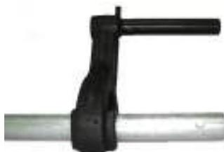
**(É OBRIGATÓRIO** o uso do suporte guia para executar a operação de rosca, é necessário que esteja bem fixado ao tubo para não haver danos à máquinas e ao operador.)
